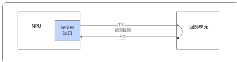
图 5-34 NPU 外部环回示意图
